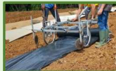
Film plastique sur dérouleuse manuelle auto-construite dans le cadre du projet RESILIANCE
