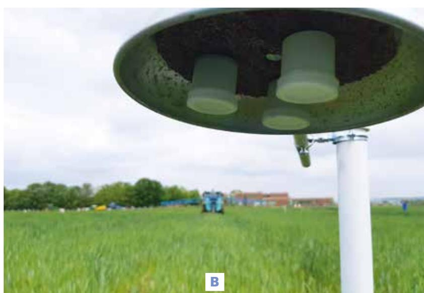
> DIAGNOSTIC DES PERTES AZOTÉES GAZEUSES : (A) DISPOSITIF DE MESURE DES CONCENTRATIONS EN AMMONIAC À PLUSIEURS HAUTEURS EN LIGNE (ROSAA), NÉCESSITANT UN COUPLAGE AVEC DES MESURES MICROMÉTÉO POUR LE CALCUL DES ÉMISSIONS ET (B) COUPELLE AVEC TROIS BADGES ALPHA UTILISÉS POUR LA MESURE DE CONCENTRATION EN AMMONIAC ATMOSPHÉRIQUE.
