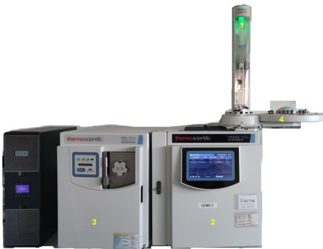
Figure 18 : Photographie présentant le GC-MS3 (1 : injecteur automatique) ; 2 : GC (chromatographe en phase gazeuse) ; 3 : MS (spectromètre de masse Thermo scientific®) ; 4 : tourniquet pour déposer les échantillons) (Barry F., 2026)
