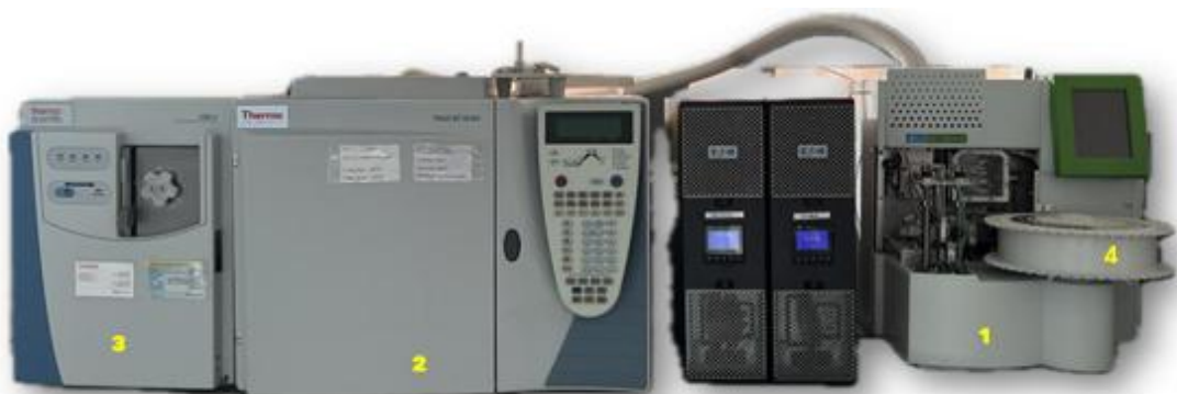
Figure 17 : Photographie présentant le GC-MS1 (1 : TD (thermodésorbeur PerkinElmer®) ; 2 : GC (chromatographe en phase gazeuse) ; 3 : MS (spectromètre de masse Thermo scientific®) ; 4 : tourniquet pour déposer les cartouches) (Barry F., 2026).
