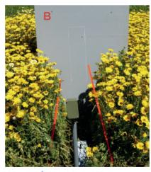
DE DISPOSITIES DE PRISE DE VUE PEUVENT ÊTRE MIS EN PLACE : UN DISPOSITIF « EXCLUSIF » (A) ET UN DISPOSITIF « INTRUSIF » (B).
