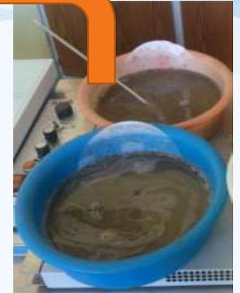
*Mise en suspension des échantillons de sol*
